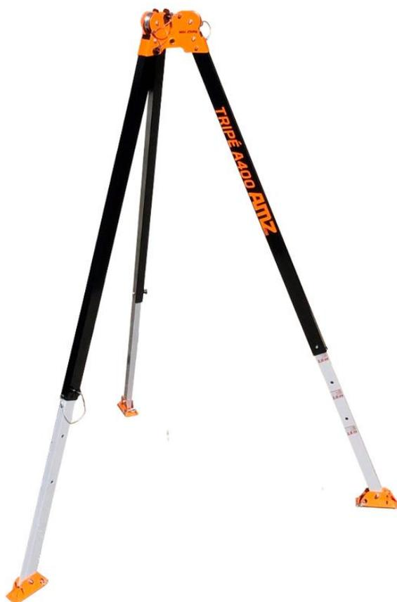
O A400 pertence a linha A de Ancoragem da AMZ. Dispositivo de ancoragem, possui no cabeçote dois sistemas de roldana de reenvio de cabo para sistema de guincho AMZ a ser instalado na perna e três pontos de ancoragem, que podem ser utilizados de forma simultânea. Possibilita 7 regulagens para a altura. Acompanha fita de fixação das pernas. Indicado para gerar ponto de ancoragem de acesso e resgate sobre boca de visita de espaço confinado ou outras estruturas similares.
