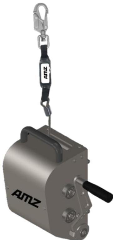
O **G200** pertence a linha G de resGate da AMZ. Funciona como guincho para acesso, posicionamento e resgate – **NÃO DEVE SER UTILIZADO PARA RETENÇÃO DE QUEDA**. Sua linha é em cabo de aço, conector com sistema distorcedor, absorvedor de energia como garantia a proteção do usuário contra impactos não previstos e este também funciona como indicador de estresse inadvertido no equipamento.
